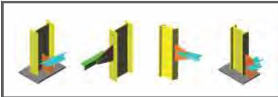
BRACING CONNECTION - CHANNEL BRACING
