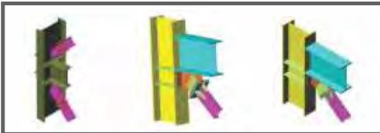
SHEAR CONNECTION - BEAM TO BEAM
